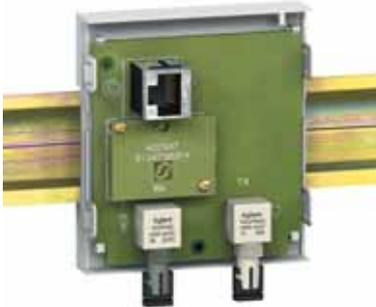
Interfaccia di collegamento a una rete di comunicazione in fibra ottica
