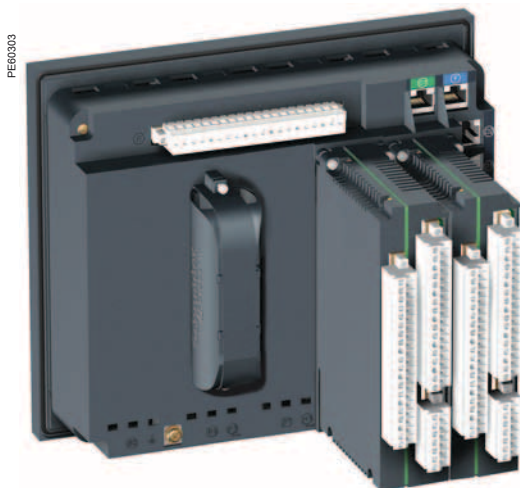
Configurazione massima del Sepam serie 60 con 2 moduli MES120: 28 ingressi e 16 uscite.
